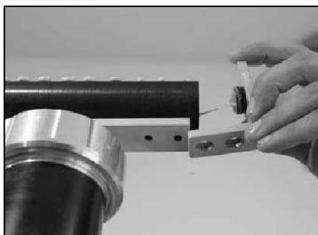
Снять правую и левую защитные крышки.
