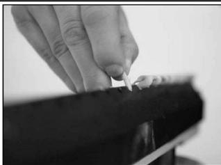
Если потребуется продолжать работу с устройством SikaBond® Dispenser-1800 Power, необходимо вытащить из отверстий распределителя застывшие «червячки» клея.
