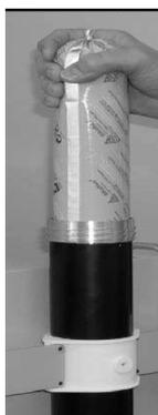
3. Поршень продвинуть назад в трубе новым трубчатым пакетом.
